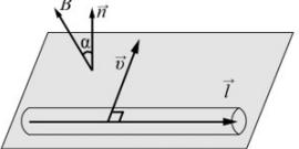
ЭДС индукции в прямом проводнике длиной $l$ , движущемся со скоростью $v$ в однородном магнитном поле $B$ :<br>$ E_i  = Blv \cos \alpha$ , где $\alpha$ – угол между вектором $B$ и нормалью |
